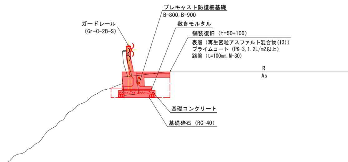
注) 施工に際しては、起工測量を行い、ガードレール基礎の割付図を作成し、監督員の承諾を得ること
